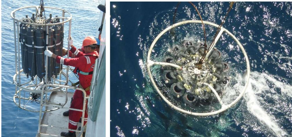
Gambar 3. 4 Proses pengambilan data menggunakan alat CTD.
