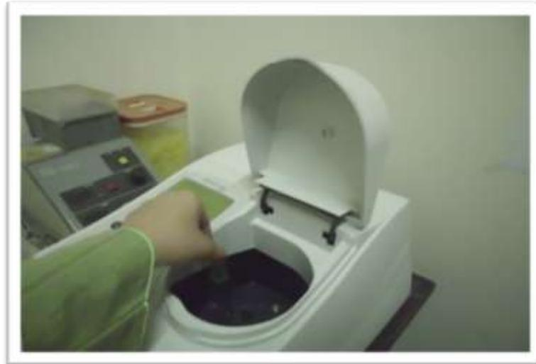
**Gambar 3.3** Pengujian Kadar Klorofil dengan Spektrofotometer
