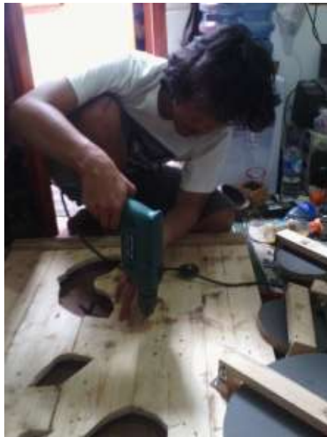
Gambar 3.91 Proses Melubangi Kayu untuk Memasang Dudukan Roda Gigi (Dokumentasi Penulis)
