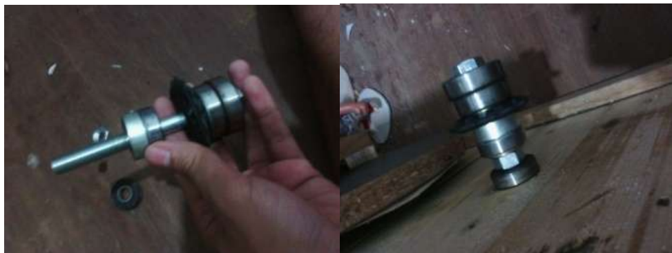
Gambar 3.94 Merangkai Tuas (Kiri) dan Tuas yang Sudah Terangkai (Kanan) (Dokumentasi Penulis)
