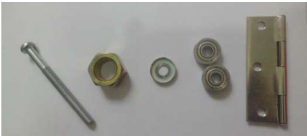
Gambar 3.31 (Kiri ke Kanan) As, Mur, Ring, Ball Bearing , dan Plat (Dokumentasi Penulis)
