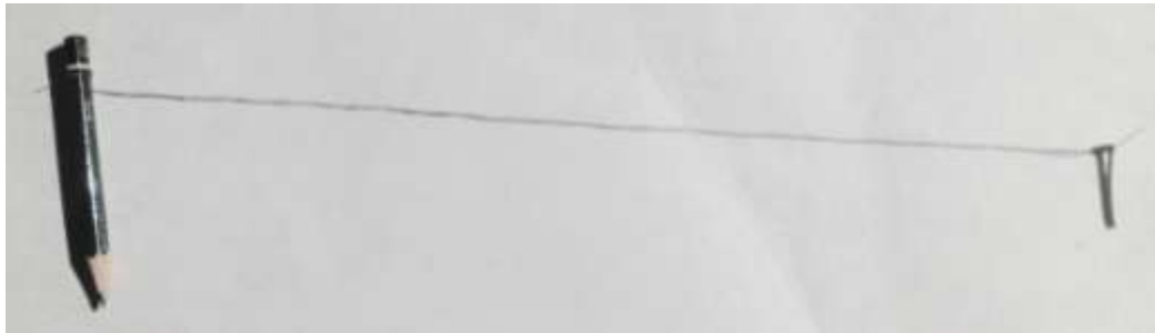
Gambar 3.11 Pensil, Paku, Benang (Jangka Rakitan Sederhana untuk Mencapai Bentuk Bulat Besar) (Dokumentasi Penulis)
