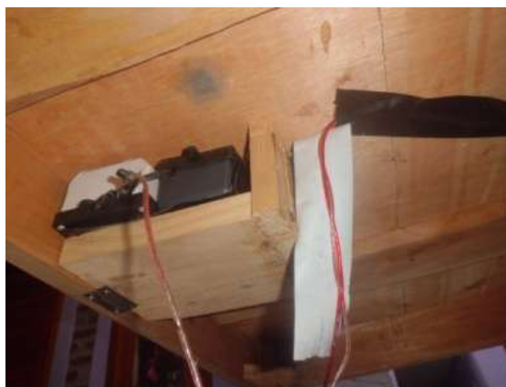
Gambar 3.73 Proses Pemasangan Dinamo (Dokumentasi Penulis)
