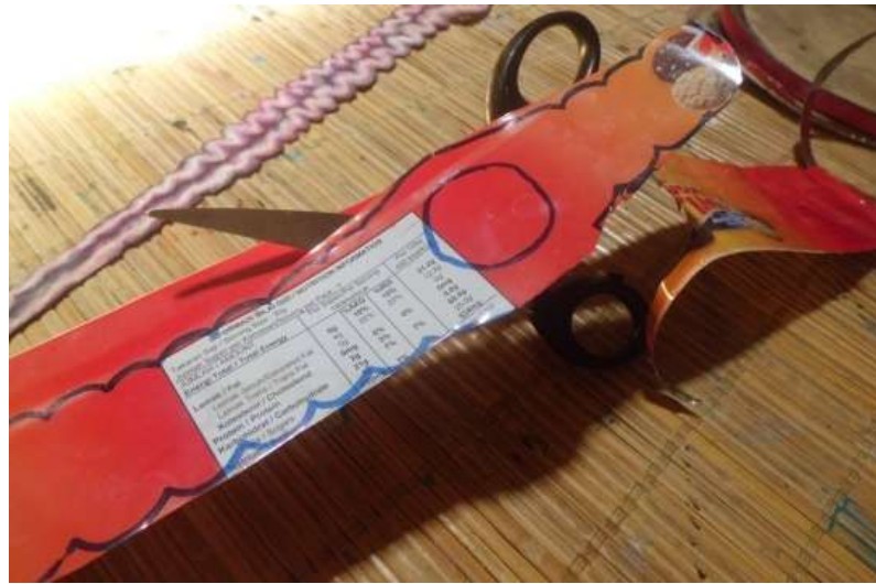
Gambar 3.45 Proses Membuat Tuas Bagian dari Rangkaian Dinamo (Dokumentasi Penulis)
