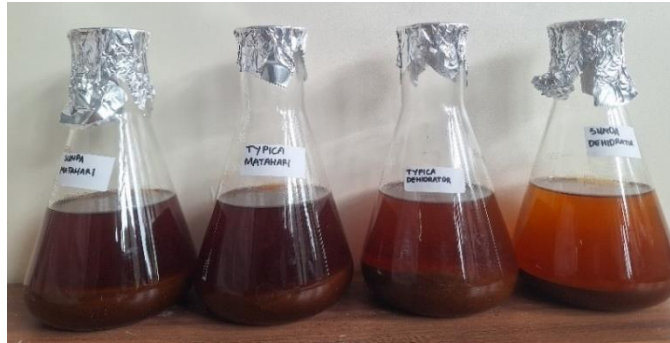
Gambar 3.10. Campuran Serbuk Simplisia dengan Pelarut Etanol P. A. 70%
