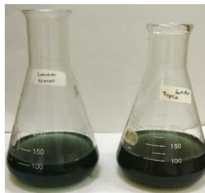
Gambar 3.7. Titrasi Uji Materi Organik Tanah (MOT)
