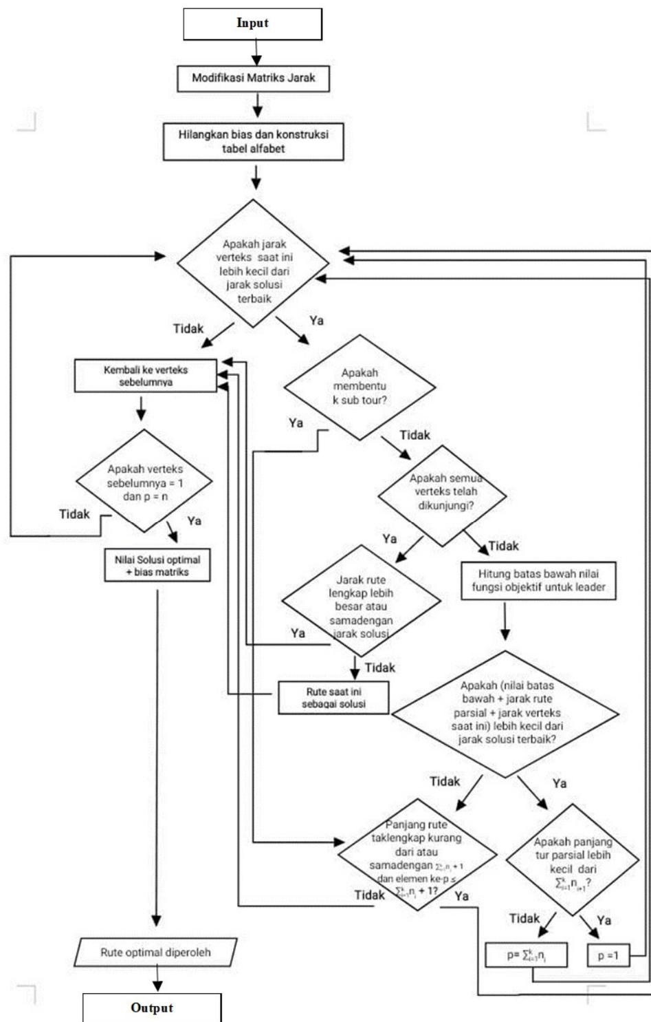
Gambar 3. 1 Langkah-Langkah Algoritma Lexisearch.
