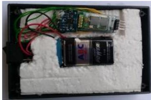
**Gambar 3.6** Tampilan dalam komponen sensor alat ukur *power* maksimal
