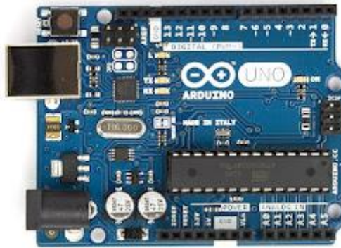
Gambar 3. 10Mikrokontroler ATmega328p (arduinoindonesia.id, 2022)
