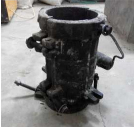
Gambar 3.9. Cetakan silinder
