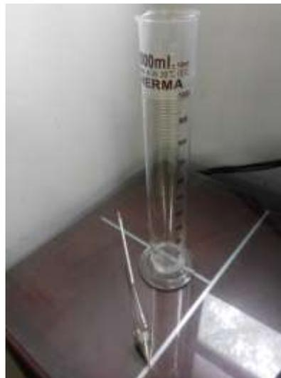
Gambar 3.7. Perlengkapan uji hidrometer
