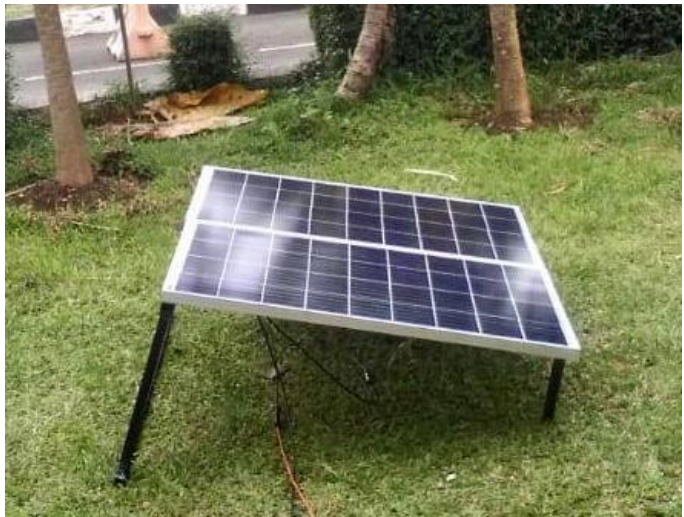
Gambar 113. Panel Surya untuk Air Bersih
