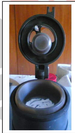
Gambar 3.5 Penggerusan dengan menggunakan alat gerus listrik.
