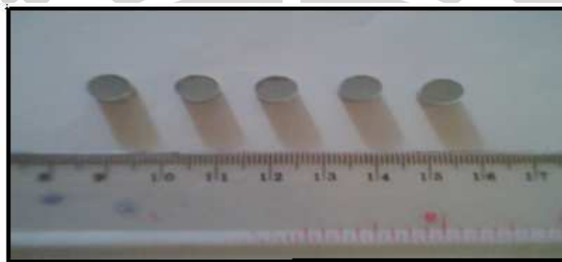
Gambar 3.10 Pelet mentah hasil kompaksi.
