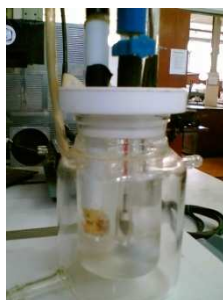
Gambar 3.2 Sel elektrokimia yang dipergunakan dalam pengukuran menggunakan metode Tafel dan EIS (data pribadi)
