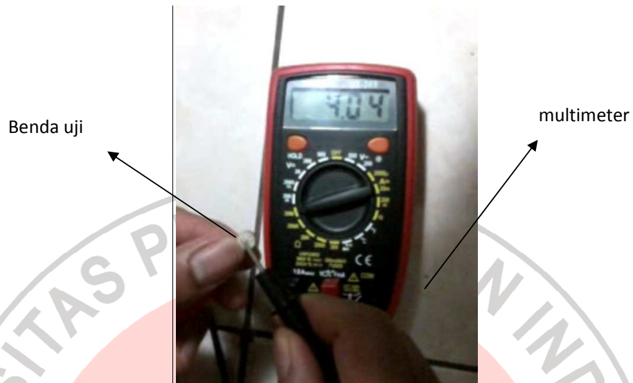
Gambar 3.11. Skema pengukuran hambatan
