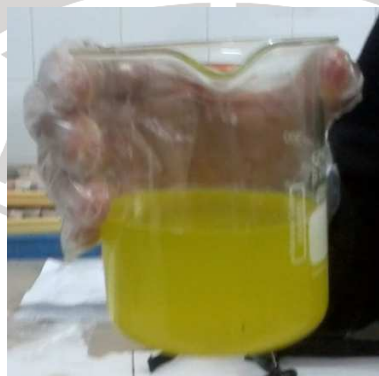
Gambar 3.6 Hasil pelindian HCl pada suhu 80^{\circ}C yang belum difiltrasi.
