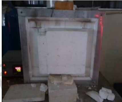
Gambar 3.4. Proses kalsinasi pada suhu 700^{\circ}\text{C} .
