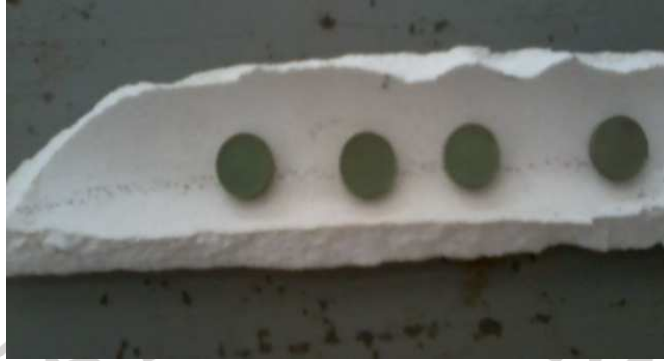
Gambar 3.9. Sampel setelah sintering pada suhu 1500^{\circ}\text{C} selama 4 jam.
