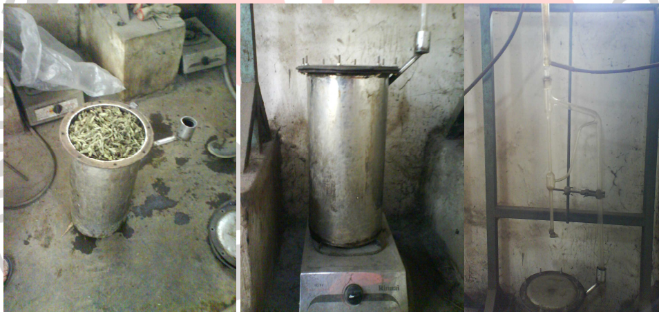
Gambar 3.2 Set Alat destilasi uap
