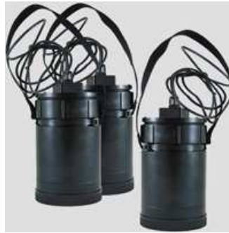
Gambar 3.3 Sensor Medan Listrik Berupa Porospot
