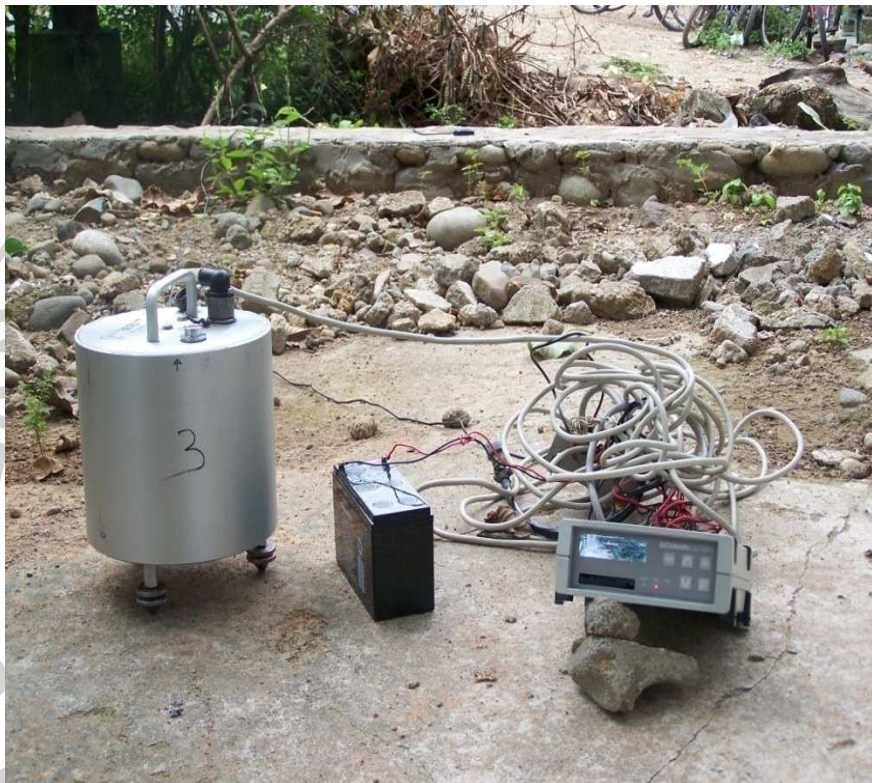
Gambar 3.2 Peralatan pengukuran amplifikasi (Seismometer L4-3D, baterai, dan data logger). (sumber : PVMBG)
