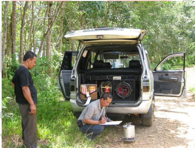
Gambar 3.3 Proses pengambilan data mikrotremor
