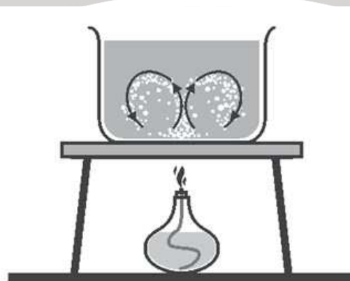
Gambar 2.2 Perpindahan panas secara konveksi
