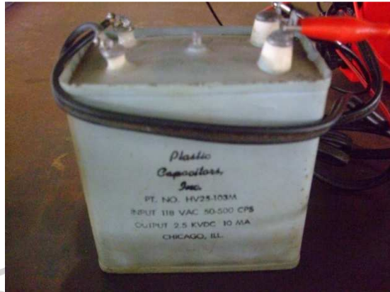
Gambar 3.33 Converter tegangan AC ke DC.
