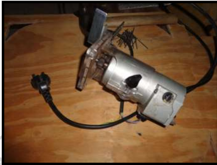
Gambar 3.5 Router (Sumber : Dokumentasi pribadi)
