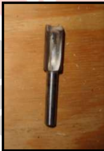
Gambar 3.6 Mata router ukuran 1/2 (Sumber: Dokumentasi pribadi)
