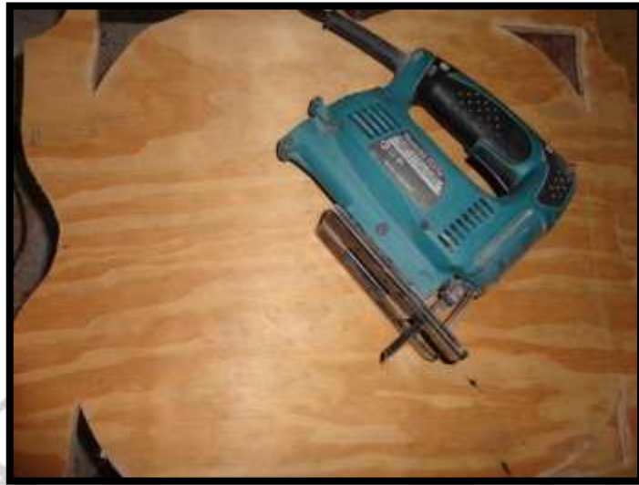
Gambar 3.3 Gergaji mesin (Jigsaw) (Sumber: Dokumentasi pribadi)
