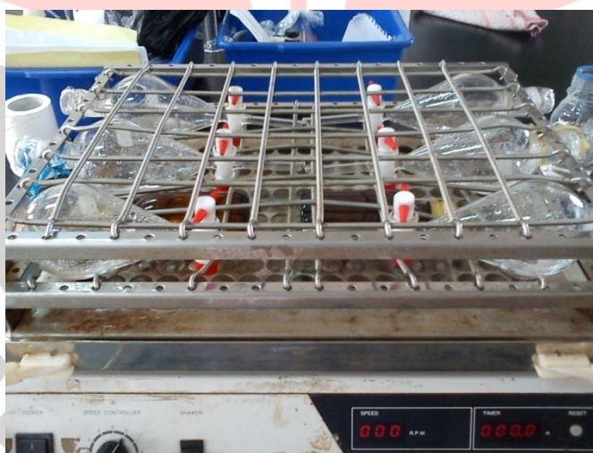
Gambar 3.4 Set alat pengocok yang digunakan untuk ekstraksi
