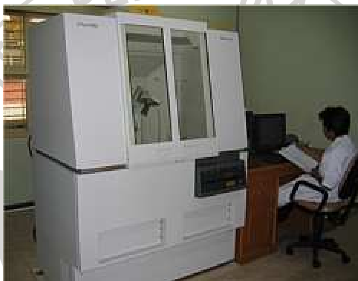
Gambar 3.5 Seorang operator yang sedang mengoperasikan mesin XRD
