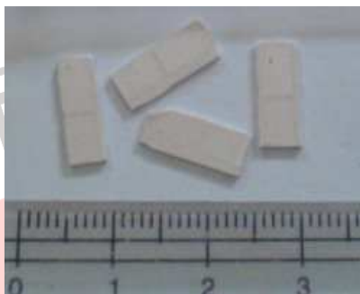
Gambar 3.3 Keramik film tebal \text{SnO}_2\text{-Ta}_2\text{O}_5 yang telah diberi kontak perak
