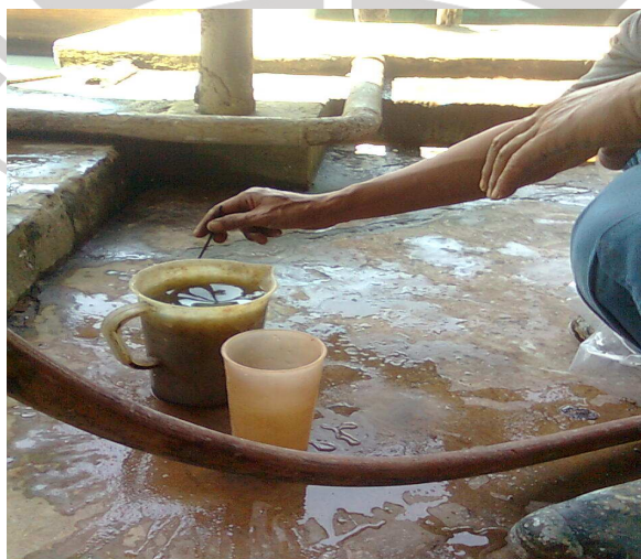
Gambar 3.3 Uji Dosis Pemberian Flokulan Sumber: Dokumentasi Pribadi
