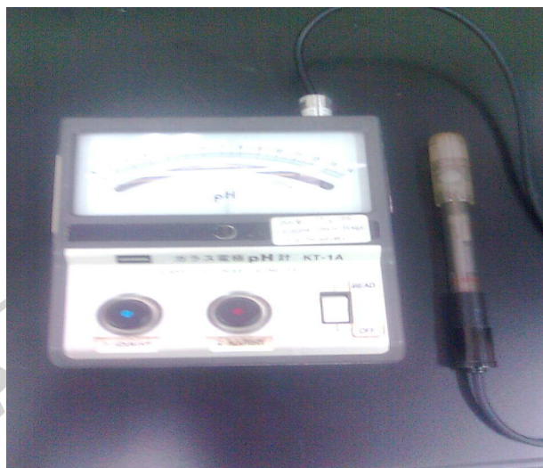
Gambar 3.9 pH meter Fisher model 156 Sumber : Dokumentasi Pribadi
