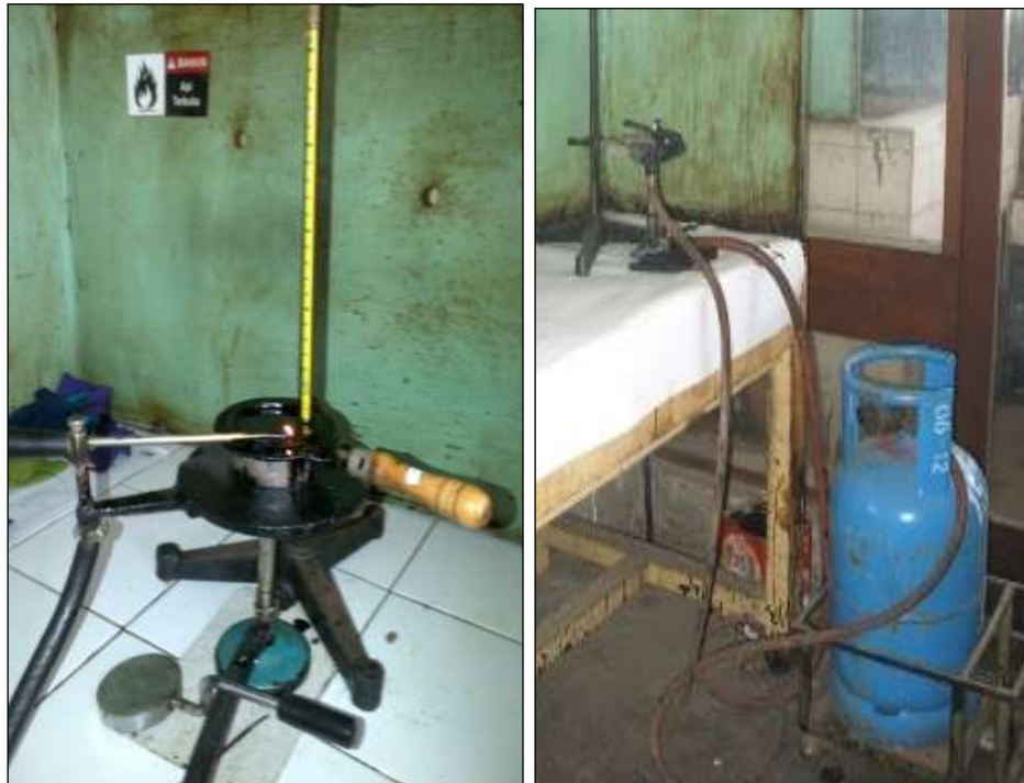
Gambar 3.33 Satu Set Alat Uji Titik Nyala dan Titik Bakar dengan Claveland Open Cup
