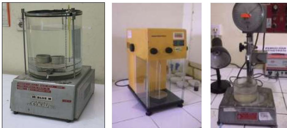
Gambar 3.32 Satu Set Alat Uji Penetrasi Bahan Bitumen / Aspal
