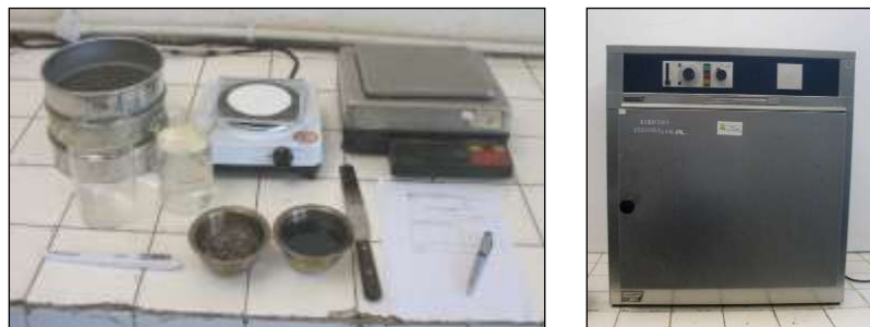
Gambar 3.21 Satu Set Alat Uji Kelekatan Agregat Terhadap Aspal Sumber : Dokumentasi Balai Bahan dan Perkerasan Jalan
