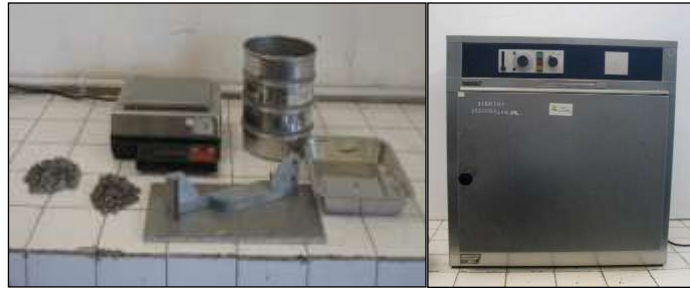
Gambar 3.25 Satu Set Alat Uji Butiran Agregat Kasar pipih, lonjong, atau pipih dan Lonjong
