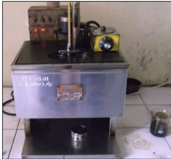
Gambar 3.45 Satu Set Alat Uji Viskositas ( Saybolt Furol Second ) Sumber : Dokumen Pribadi
