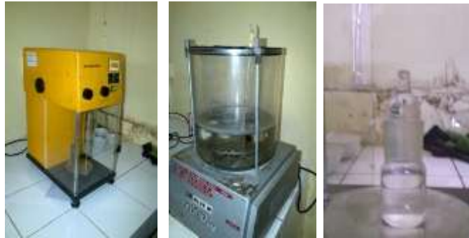
Gambar 3.39 Satu Set Alat Uji Berat Jenis Aspal Sumber : Dokumentasi Balai Bahan dan Perkerasan Jalan
