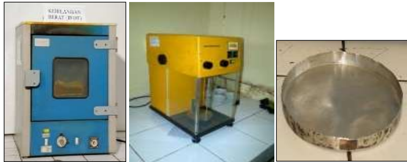
Gambar 3.43 Satu Set Alat Uji TFOT
