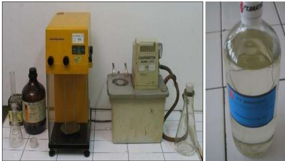
Gambar 3.41 Satu Set Alat Uji Kelarutan Aspal dengan TCE Sumber : Dokumentasi Balai Bahan dan Perkerasan Jalan
