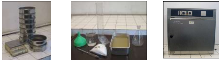
Gambar 3.29 Satu Set Alat Uji Sifat Kekekalan Bentuk Agregat terhadap Larutan Natrium Sulfat dan Magnesium Sulfat
