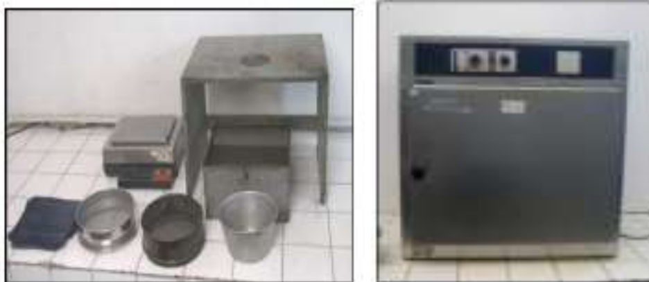
Gambar 3. 12 Satu Set Alat Uji Berat Jenis dan Penyerapan Agregat Kasar Sumber : Dokumentasi Balai Bahan dan Perkerasan Jalan
