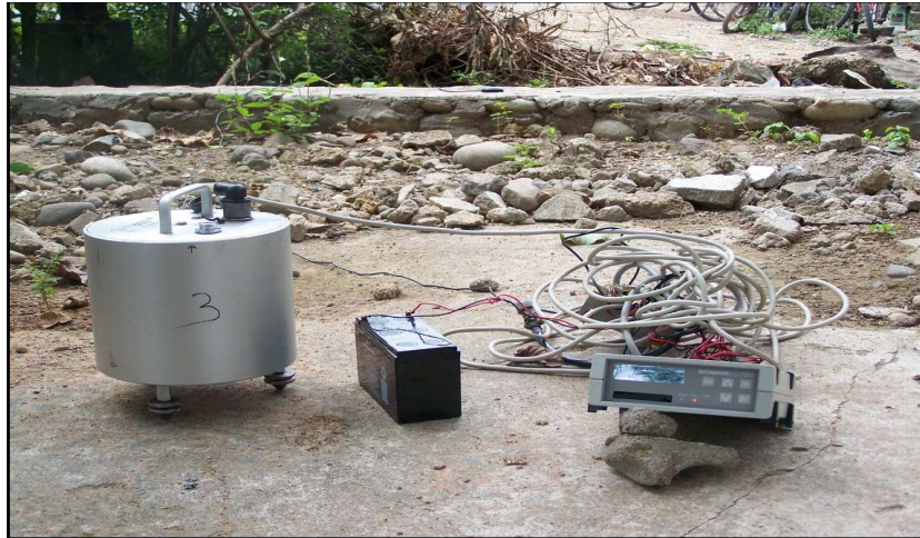
Gambar 3.2. Satu set peralatan mikrotremor (Seismometer L4-3D)
