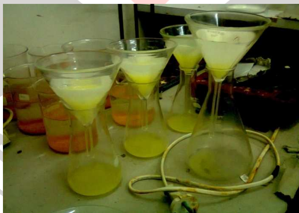
Gambar 3.6 Proses filtrasi setelah pelindian HCl
