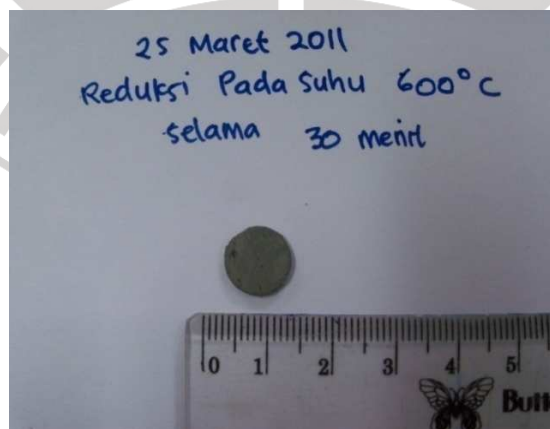
Gambar 3.8 Sampel yang telah direduksi pada suhu 600^{\circ}\text{C}
