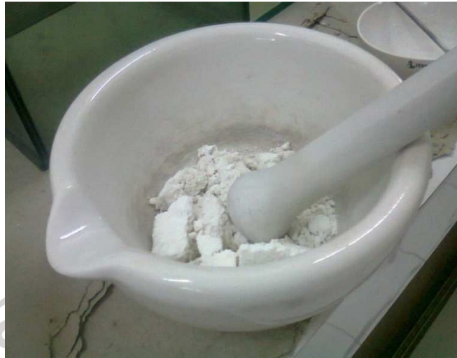
Gambar 3.4 Sampel yang telah dikalsinasi pada suhu 700 °C
