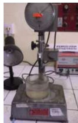
Gambar 3.32 Satu Set Alat Uji Penetrasi Bahan Bitumen / Aspal
