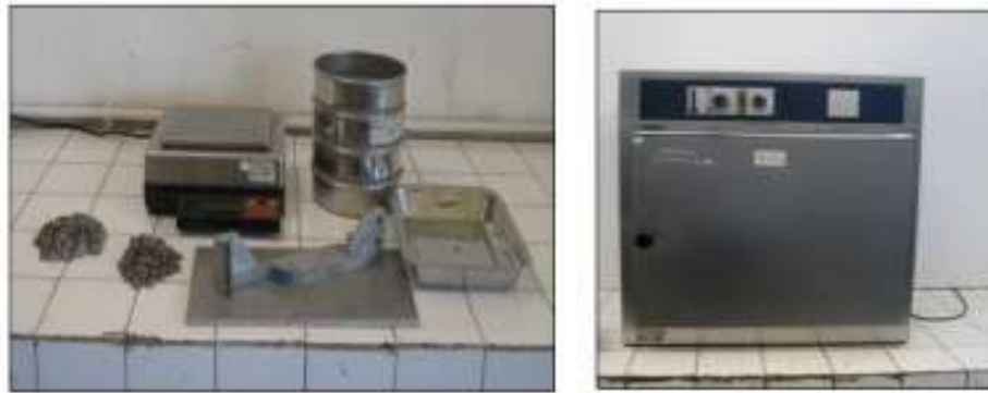
Gambar 3.25 Satu Set Alat Uji Butiran Agregat Kasar pipih, lonjong, atau pipih dan Lonjong
