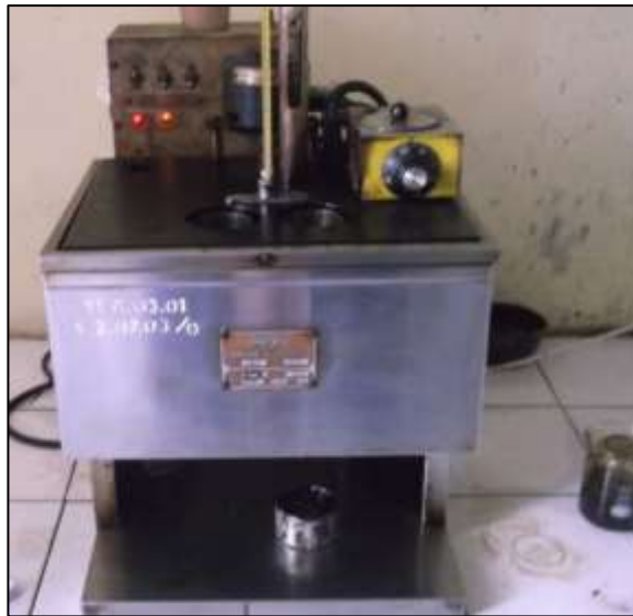
Gambar 3.45 Satu Set Alat Uji Viskositas (Saybolt Furol Second)
