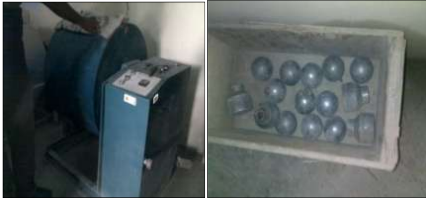
Gambar 3.8 Mesin Abrasi Los Angeles Sumber : Dokumentasi Pribadi
