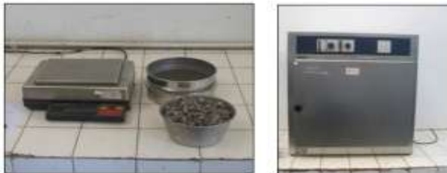
Gambar 3.17 Satu Set Alat Uji Angularitas Agregat Kasar
