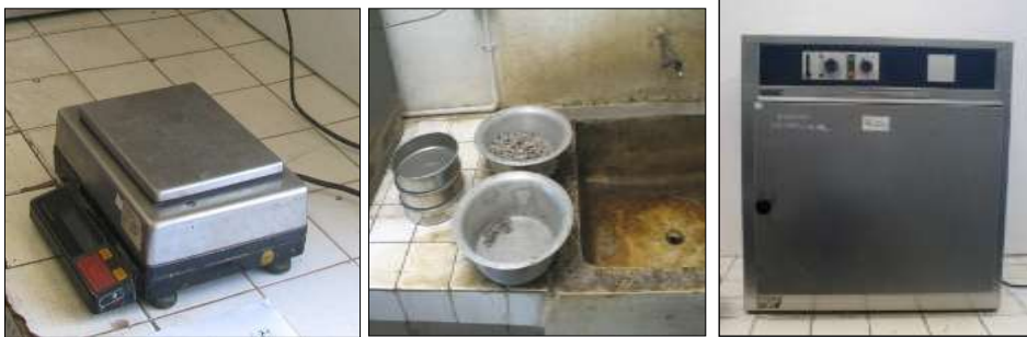
Gambar 3.27 Satu Set Alat Uji Material Yang Lolos Saringan No. 200 Sumber : Dokumentasi Balai Bahan dan Perkerasan Jalan
