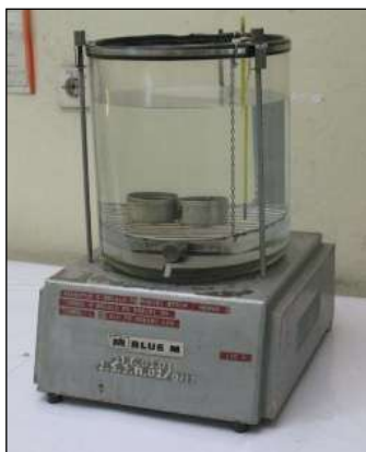
Gambar 3.32 Satu Set Alat Uji Penetrasi Bahan Bitumen / Aspal
