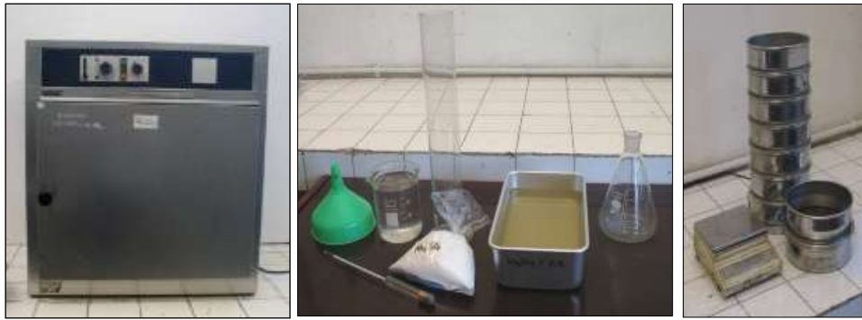
Gambar 3.29 Satu Set Alat Uji Sifat Kekekalan Bentuk Agregat terhadap Larutan Natrium Sulfat dan Magnesium Sulfat
