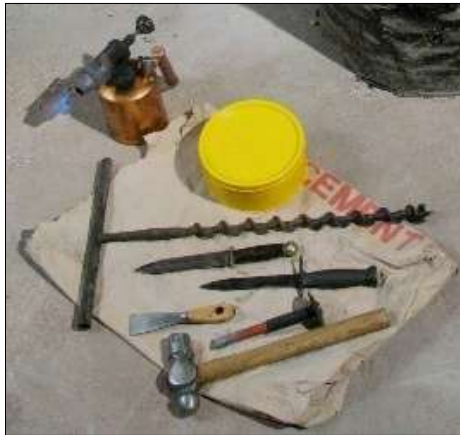
Gambar 3.30 Satu Set Alat Pengambil Contoh Aspal Sumber : Dokumentasi Balai Bahan dan Perkerasan Jalan
