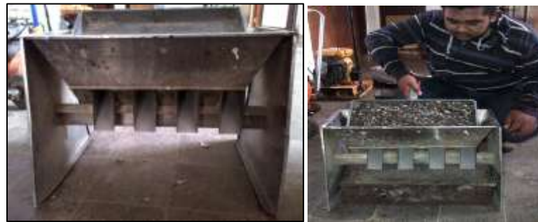
Gambar 3.6 Alat uji splitter Sumber : Dokumentasi pribadi
