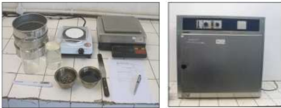
Gambar 3.21 Satu Set Alat Uji Kelekatan Agregat Terhadap Aspal
