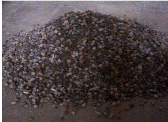
Gambar 3. 1 Agregat Kasar yang Digunakan Sumber : Dokumen Pribadi
