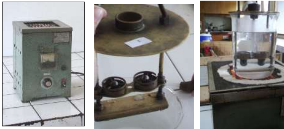
Gambar 3.35 Satu Set Alat Uji Titik Lembek Aspal
