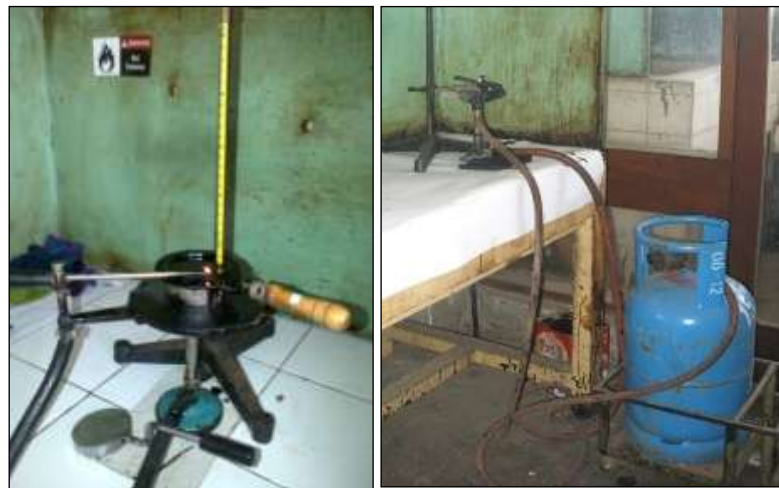
Gambar 3.33 Satu Set Alat Uji Titik Nyala dan Titik Bakar dengan Claveland Open Cup Sumber : Dokumentasi Pribadi
