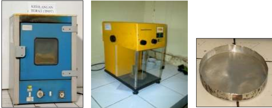
Gambar 3.43 Satu Set Alat Uji TFOT Sumber : Dokumentasi Balai Bahan dan Perkerasan Jalan
