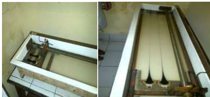
Gambar 3.37 Satu Set Alat Uji Daktilitas Aspal Sumber : Dokumentasi Pribadi
