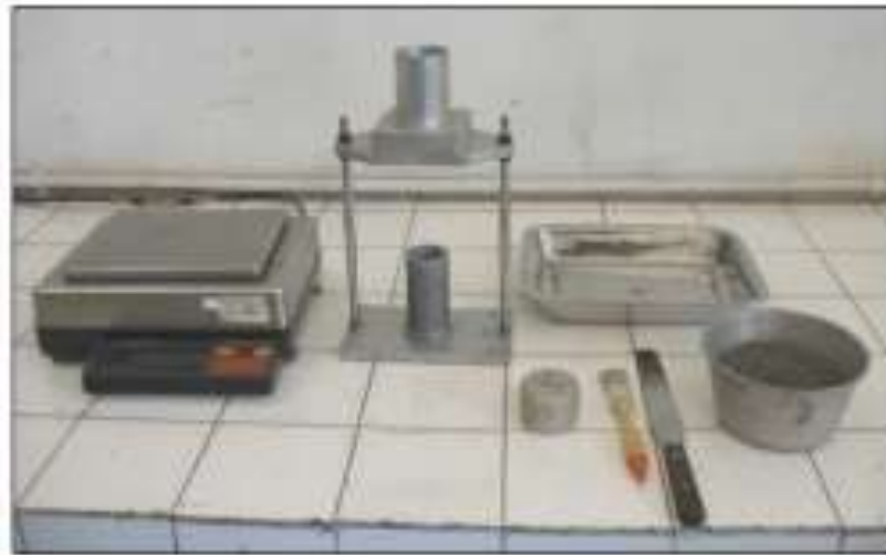
Gambar 3.19 Satu Set Alat Uji Angularitas Agregat Halus Sumber : Dokumentasi Balai Bahan dan Perkerasan Jalan
