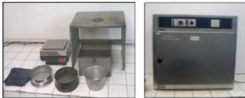
Gambar 3.12 Satu Set Alat Uji Berat Jenis dan Penyerapan Agregat Kasar Sumber : Dokumentasi Balai Bahan dan Perkerasan Jalan
