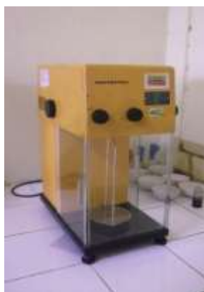
Gambar 3.32 Satu Set Alat Uji Penetrasi Bahan Bitumen / Aspal
