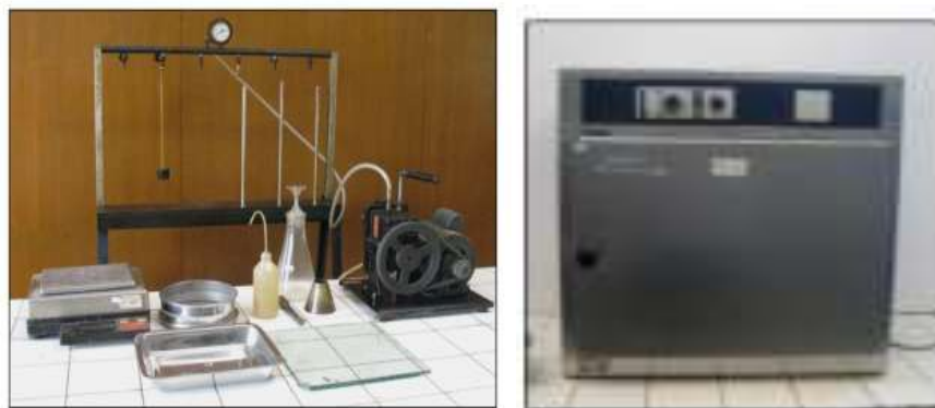
Gambar 3.14 Satu Set Alat Uji Berat Jenis dan Penyerapan Agregat Halus
