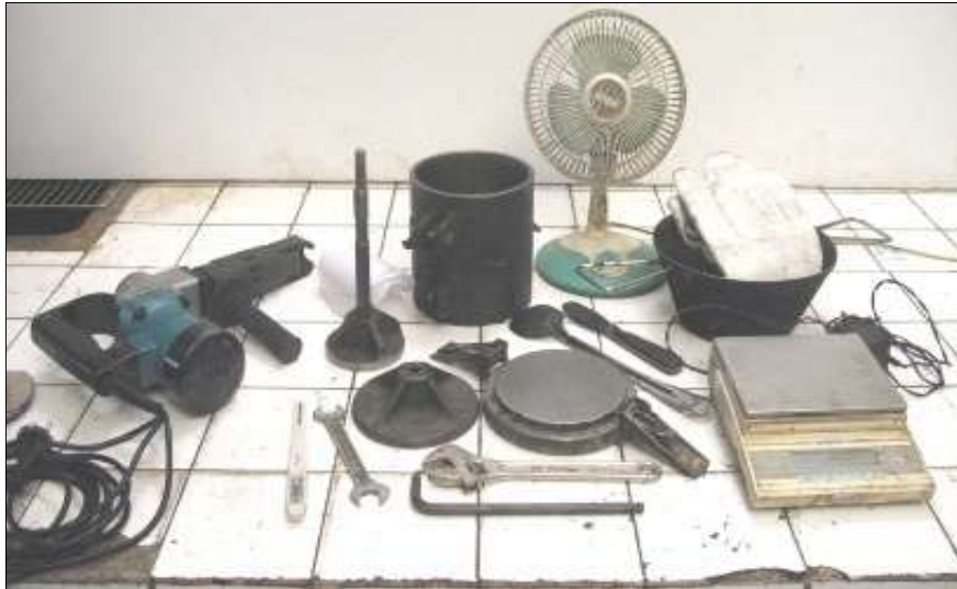
Gambar 3.48 Satu Set Alat Uji Kepadatan Mutlak Sumber : Dokumentasi Balai Bahan dan Perkerasan Jalan
