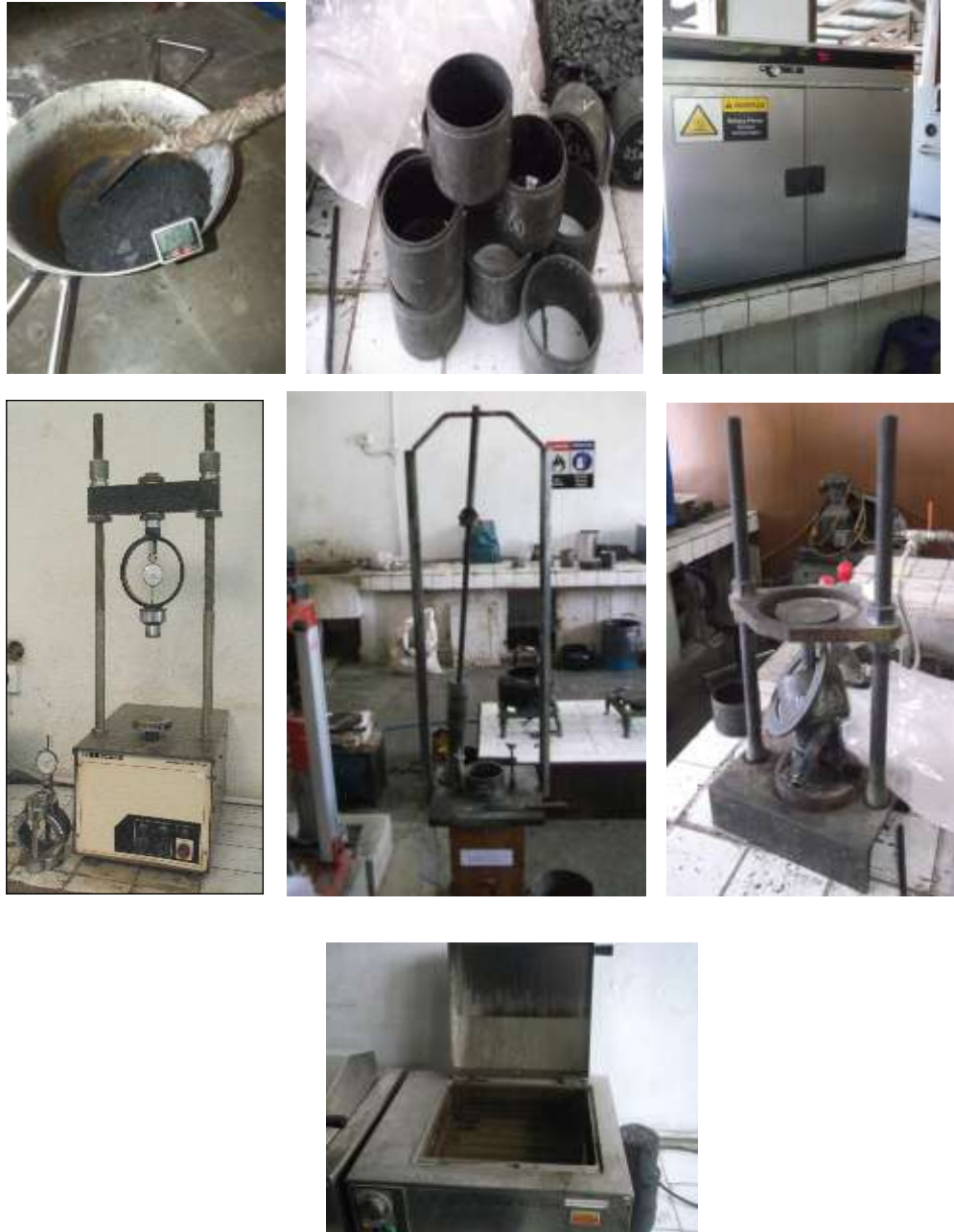
Gambar 3.47 Satu Set Alat Uji Marshall Test Sumber : Dokumentasi Balai Bahan dan Perkerasan Jalan
