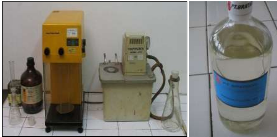
Gambar 3.41 Satu Set Alat pengujian kelarutan aspal terhadap TCE Sumber : Dokumentasi Balai Bahan dan Perkerasan Jalan
