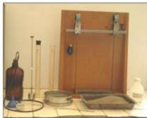
Gambar 3.23 Satu Set Alat Uji Agregat Halus atau Pasir yang mengandung Bahan Plastik dengan Cara Setara Pasir
