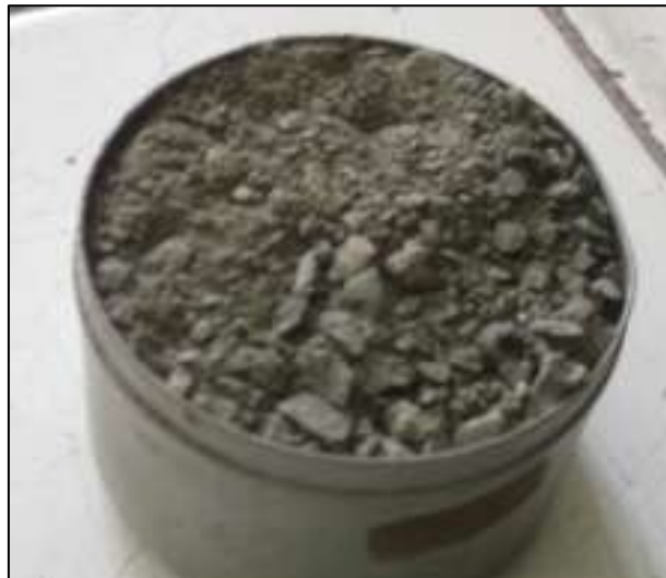
Gambar 3. 2 Agregat Halus yang Digunakan Sumber : Dokumen Pribadi
