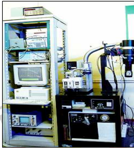
Gambar 3.7 Susunan peralatan pengukuran karakterisasi I – V.
