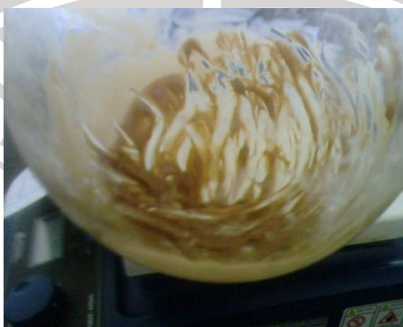
**Gambar 4.2** *Oleil Imidazolinium* hasil metilasi dengan  $\text{CH}_3\text{I}$
