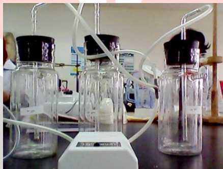
Gambar 3.2 Alat weight loss yang digunakan untuk pengukuran penurunan berat dalam penentuan laju korosi.
