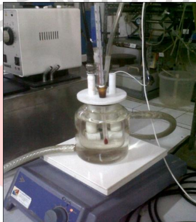
Gambar 3.3 Sel elektrokimia yang digunakan untuk penentuan laju korosi dengan metode EIS dan Tafel.
