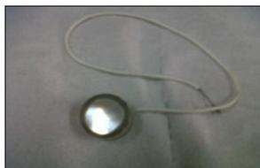
**Gambar 3.6** Elektroda kerja
