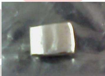
**Gambar 3.5** Spesimen uji *Weight Loss*.
