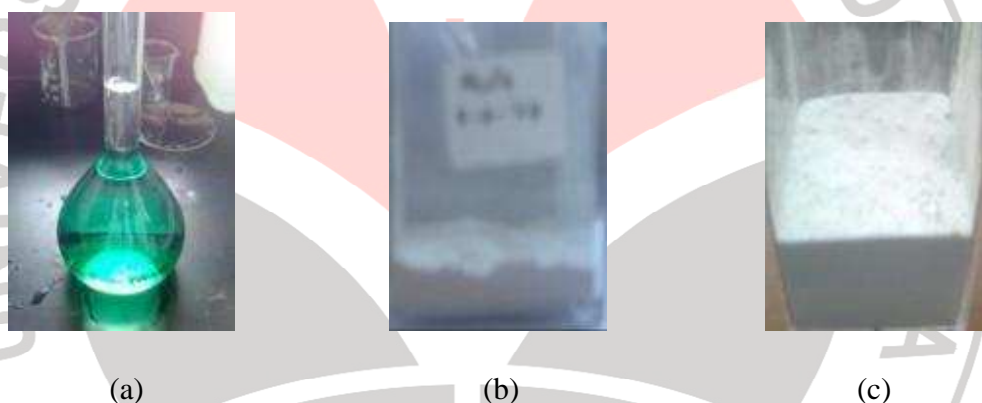
Gambar 4.1. (a). Larutan garam prekursor Ni(NO 3 ) 2 ·6H 2 O 0,25 M, (b). Material pendukung (Al 2 O 3 ), (c). Katalis NiO/Al 2 O 3 .
