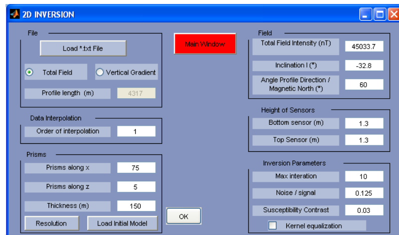
Gambar 3.4. Tampilan program Mag2D yang digunakan dalam Proses pencocokan Data
