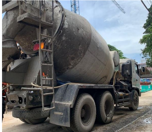
Gambar 3.4.3 Truck Mixer Hino Ranger Mixer FM 260 JM (Sumber : Dokumentasi Pribadi )
