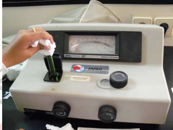
Gambar 3.11 Pengukuran Kadar Klorofil Daun dengan Spektrofotometer (Sumber : Dokumentasi Pribadi)
