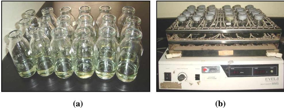
**Gambar 3.4** (a). Krom nitrat sebelum dikontakkan, (b). Proses agitasi saat pengontakkan (Sumber: dokumentasi pribadi).
