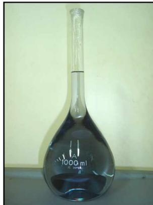
**Gambar 3.3** Larutan stok krom nitrat ( $\text{Cr}(\text{NO}_3)_3 \cdot 9\text{H}_2\text{O}$ ) (Sumber: dokumentasi pribadi).
