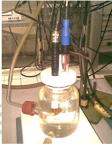
Gambar 3.2 Sel elektrokimia yang dipergunakan dalam pengukuran menggunakan metode Tafel dan EIS
