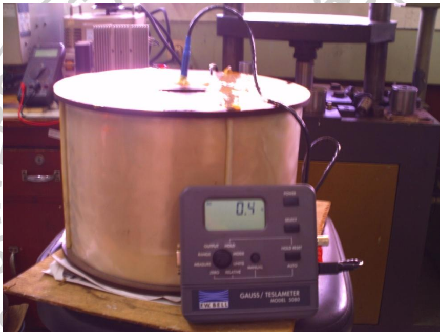
Gambar 3.12: Magnetometer dan Kumbaran Solenoida
