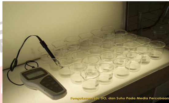
Gambar 3.6 Pengukuran konduktivitas kultur sampel larutan uji
