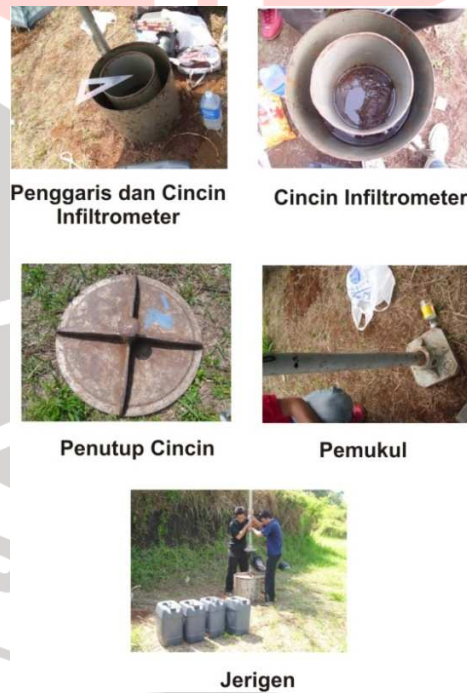
Gambar 3.1. Peralatan pengukuran infiltrasi
