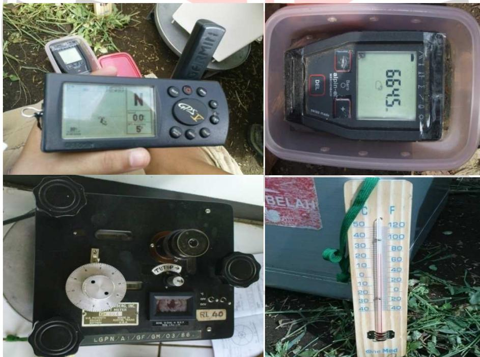
Gambar 3.1 Beberapa alat yang digunakan, dari kiri ke kanan: GPS, Altimeter, Lacoste & Romberg model G-804, dan Termometer.
