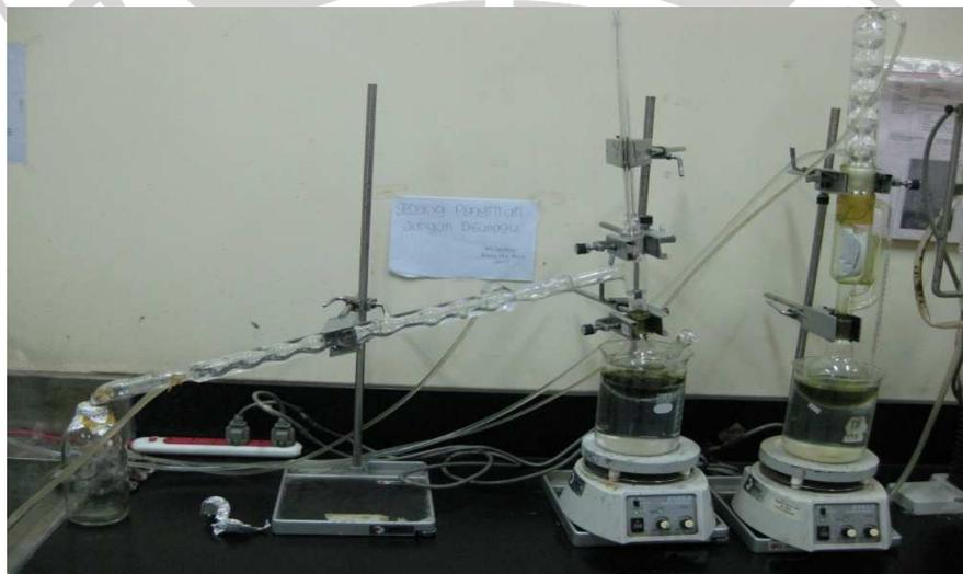
**Gambar 3.1 Alat-Alat Ekstraksi**
