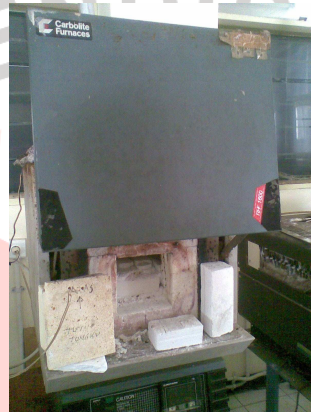
Gambar 3.5. Tungku Carbolite RHF 600 yang digunakan untuk proses sintering
