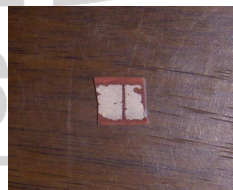
Gambar 3.8. Contoh film tebal yang sudah dimetalisasi.
