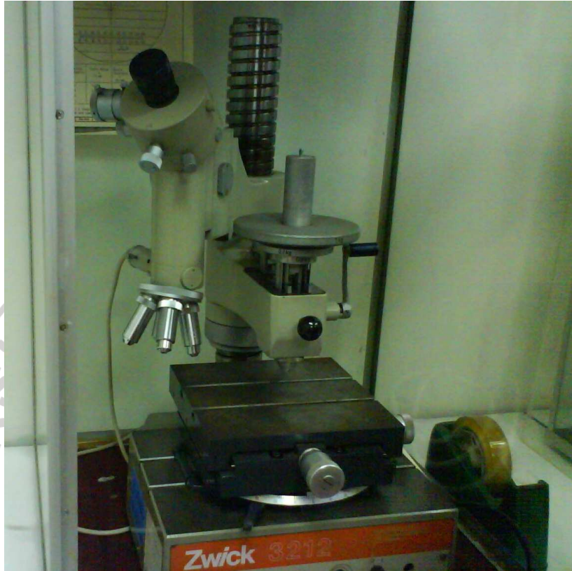
Gambar 3.8 Mesin uji Vickers (Zwick 3212), digunakan untuk mengetahui harga kekerasan dan ketangguhan patah
