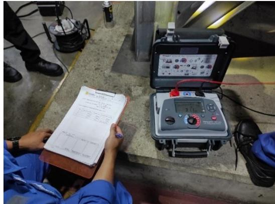
Gambar 3. 5 Pengukuran Tahanan Isolasi pada GCB
