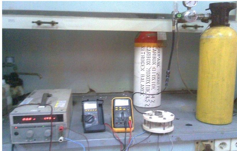
**Gambar 3.32** Pengujian Tanggapan Sensor Terhadap Rangsangan Gas
