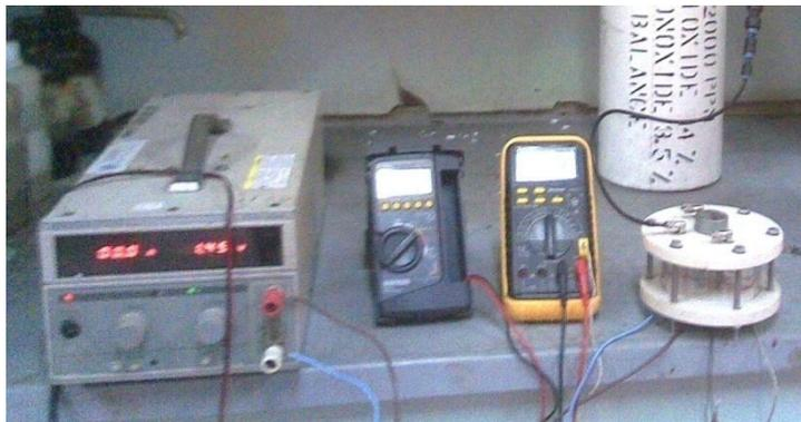
**Gambar 3.31** Pengujian Perubahan Resistansi Sensor terhadap temperatur
