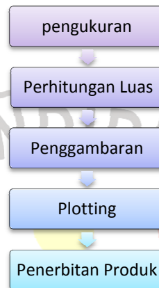
Gambar 5.3 Bagan Alir Pengukuran dan Pemetaan Bidang Tanah
