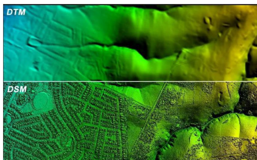
Gambar 1. 1. Perbandingan Informasi data DTM dan DSM
