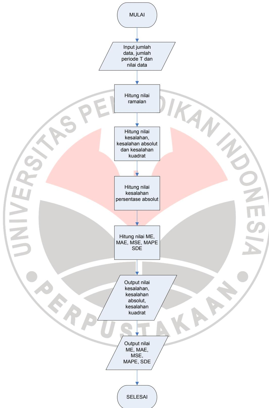
**Gambar 3.2** Diagram Alir Algoritma Metode Rata-rata Bergerak Tunggal
