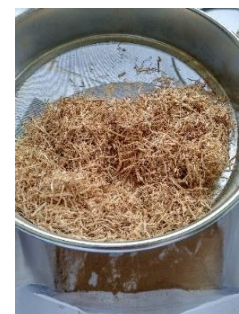
Gambar 3.11. Pengayakan Sampel menggunakan Saringan 100 mesh
