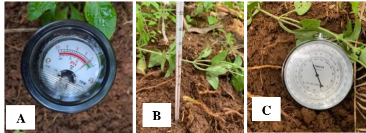
Gambar 3.5. Pengukuran Faktor Abiotik: A. Soil tester ; B. Termometer; C. Altimeter
