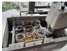
Gambar 3.16. Penguapan Ekstrak menggunakan Waterbath
