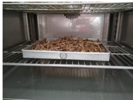
Gambar 3.9. Pengeringan Sampel menggunakan Inkubator Suhu 50°C
