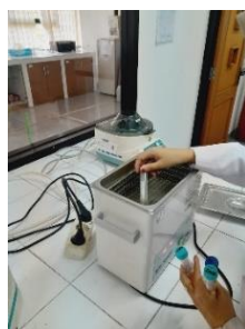
Gambar 3.22. Penghomogenan Larutan dengan Ultrasonic Cleaner
