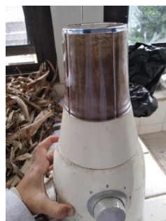
Gambar 3.10. Penghalusan Sampel menggunakan Blender
