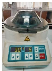
Gambar 3.23. Penghomogenan Larutan dengan Centrifuge
